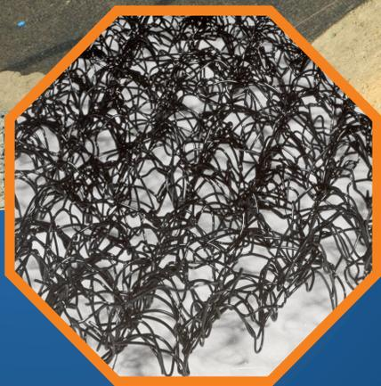
Противоэрозионный геомат - это набор хаотичных волоконных структур, состоящих из полимерных материалов, соединенных между собой механическим, либо термическим способом. Геомат состоит из большого количества пустот, что позволяет использовать его для армирования грунта.
